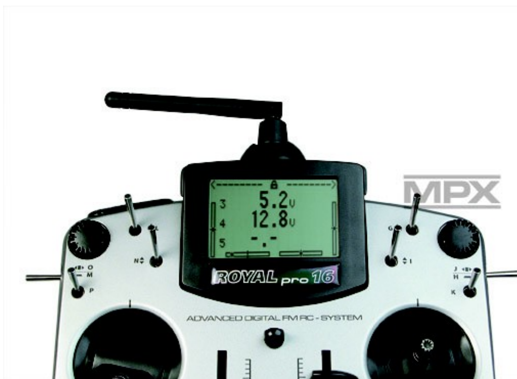
Exemple d'affichage de tension avec les entrées U1 en ligne 3 et U2 en ligne 4
