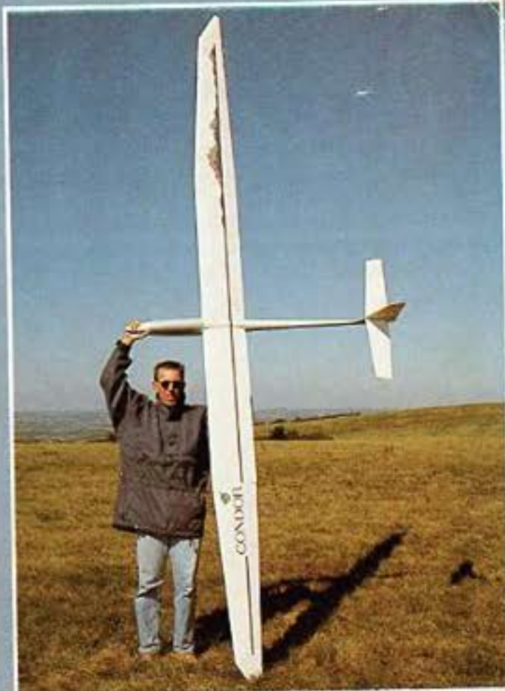
Frédéric Rémy, qui participa avec Gérard Hübner et le signataire aux nombreux essais du Condor que l'on voit pleine page en vol, vous présente ci-contre la bête : 4,20 m d'envergure, 5610 g, profil HQ. Un sacré cocktail pour une machine de performance exceptionnelle !
