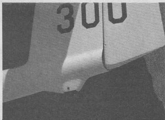
L'adjonction d'une petit roulette est bienvenue pour éviter d'user le fuselage en fibre de verre.
