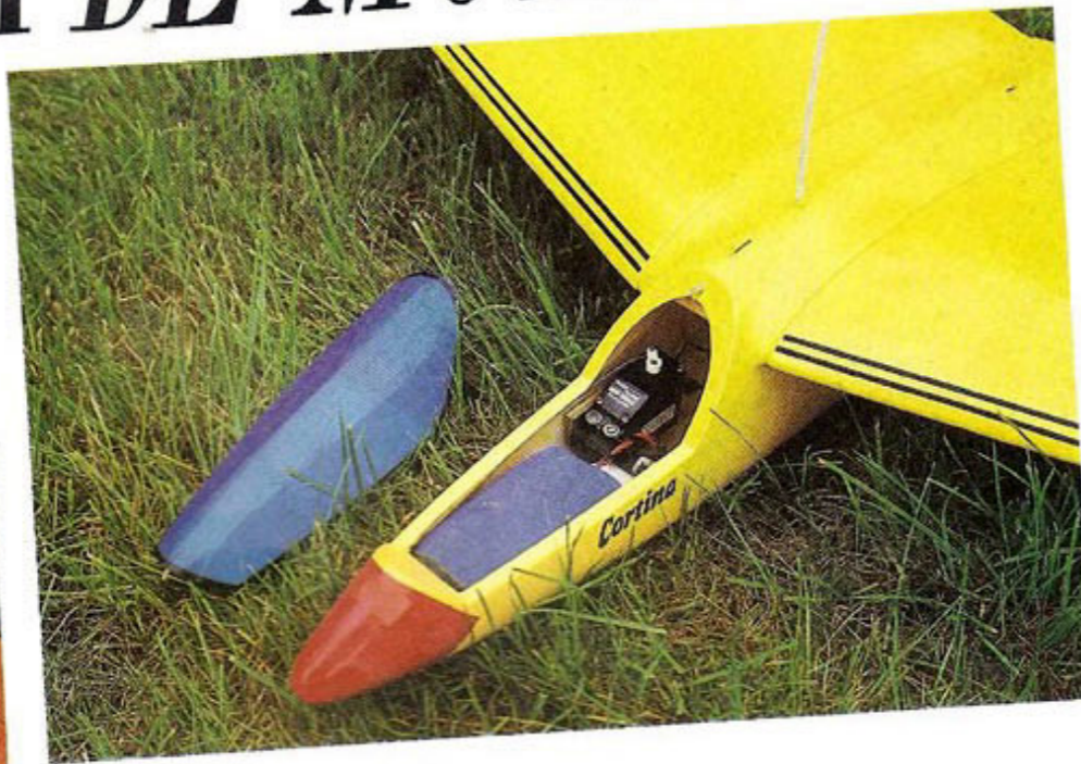
Parmi les petites modifs apportées à la Cortina : les dérives de bout d'aile réalisées en structure et d'une surface légèrement agrandie, les sorties des commandes à l'extrados, et la soute à lest aménagée à l'avant du fuselage. A droite, l'auteur et la bête qui se révèle être une grande plume originale.
