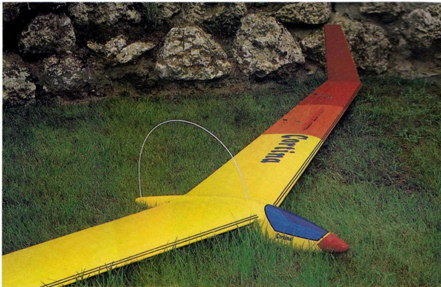
Noter ci-dessus le tube replié au-dessus du fuselage qui permet de loger l'antenne bien déployée. Ci-dessous le fuselage ne renferme en fait que deux servos : celui des aérofreins que l'on voit ici et celui du crochet de remorquage. Les servos d'ailerons et de profondeur sont logés dans les ailes et raccordés au récepteur via des rallonges dont une partie bobinée autour d'un tore en ferrite pour éviter tout parasite.
