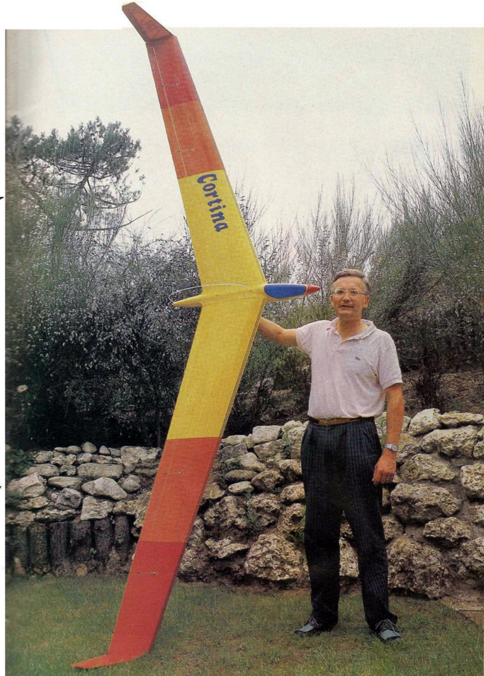
Parmi les petites modifs apportées à la Cortina : les dérives de bout d'aile réalisées en structure et d'une surface légèrement agrandie, les sorties des commandes à l'extrados, et la soute à lest aménagée à l'avant du fuselage. A droite, l'auteur et la bête qui se révèle être une grande plume originale.
