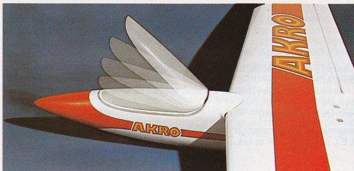
La photo illustre l'utilisation de la verrière comme aéro-frein
